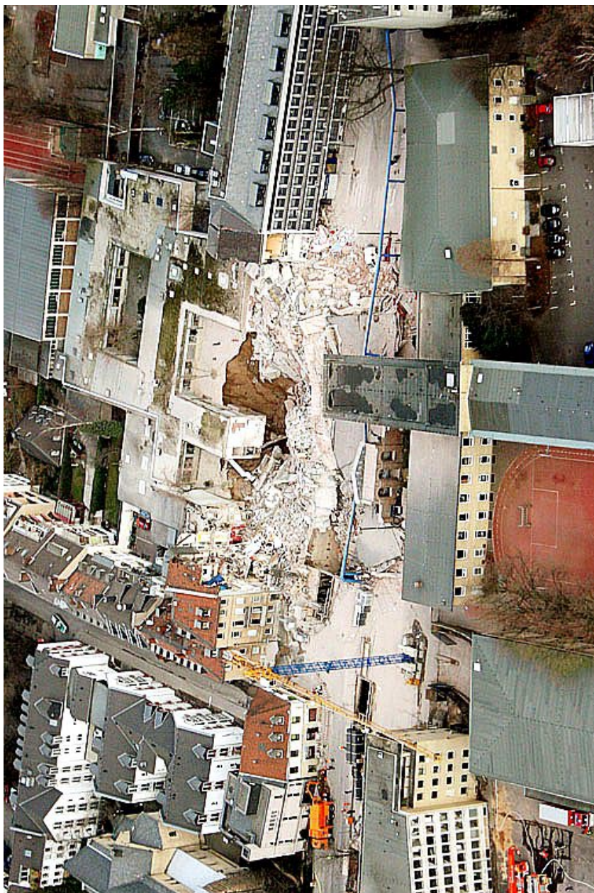
▲ Das Historische Stadtarchiv Kölns liegt total in Trümmern im durch den U-Bahnbau verursachten Tagbruch an der Severinstraße. Auch wenn die Ursachen noch nicht geklärt sind, darf vermutet werden, daß auch dieser Verbruch des Tunnelbaus [03] seine Ursache in einer nicht rechtzeitig erkannten geologischen Störzone hat. Aber wer hat da geschlafen? (Foto: 4.3.2009 – dpa)
